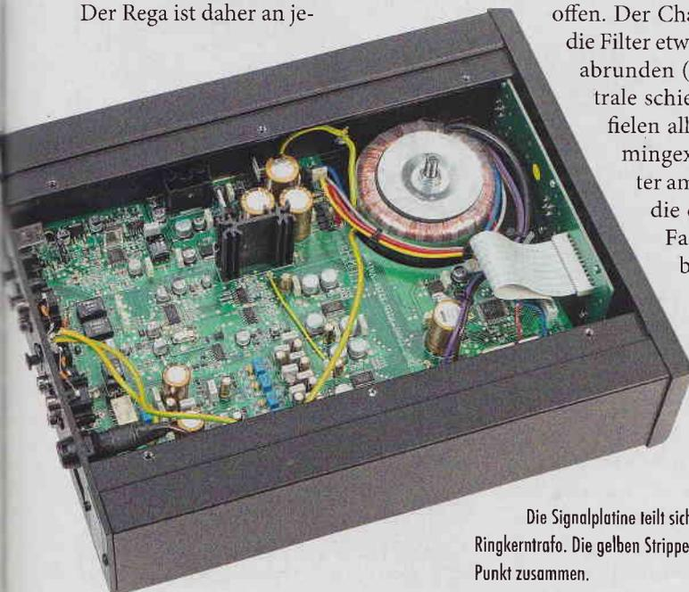
Die Signalplatine teilt sich das Gehäuse mit einem großen Ringkerntrafo. Die gelben Streifen führen alle Massen an einem Punkt zusammen.
