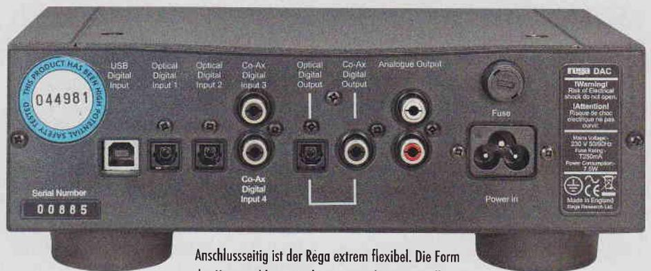
Anschlussseitig ist der Rega extrem flexibel. Die Form des Netzanschlusses ist hingegen unkonventionell.
